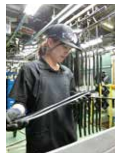
外観検査工程により、安全メガネを外して作業を実施しています。
